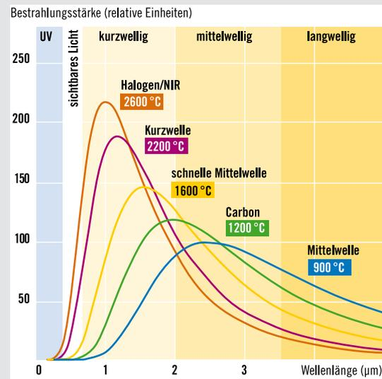
Die spektrale Strahlungsverteilung verschiedener Infrarot-Strahler, normiert auf gleiche Leistung
