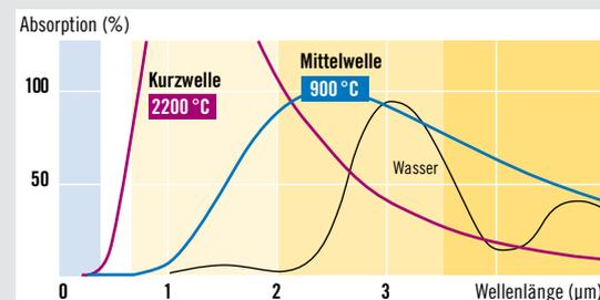
Wasser verdunstet schneller durch mittelwellige Infrarot-Strahler, denn Wasser absorbiert besonders gut in diesem Bereich.
