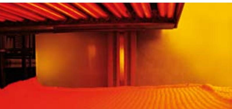
**Carbon Twin Strahler gelieren und härten Pulverlack besonders schnell**
