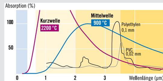
Kunststoffe, wie Polyethylen und Polyvinylchlorid, absorbieren Infrarot-Strahlung besonders gut im mittelwelligen Bereich.
