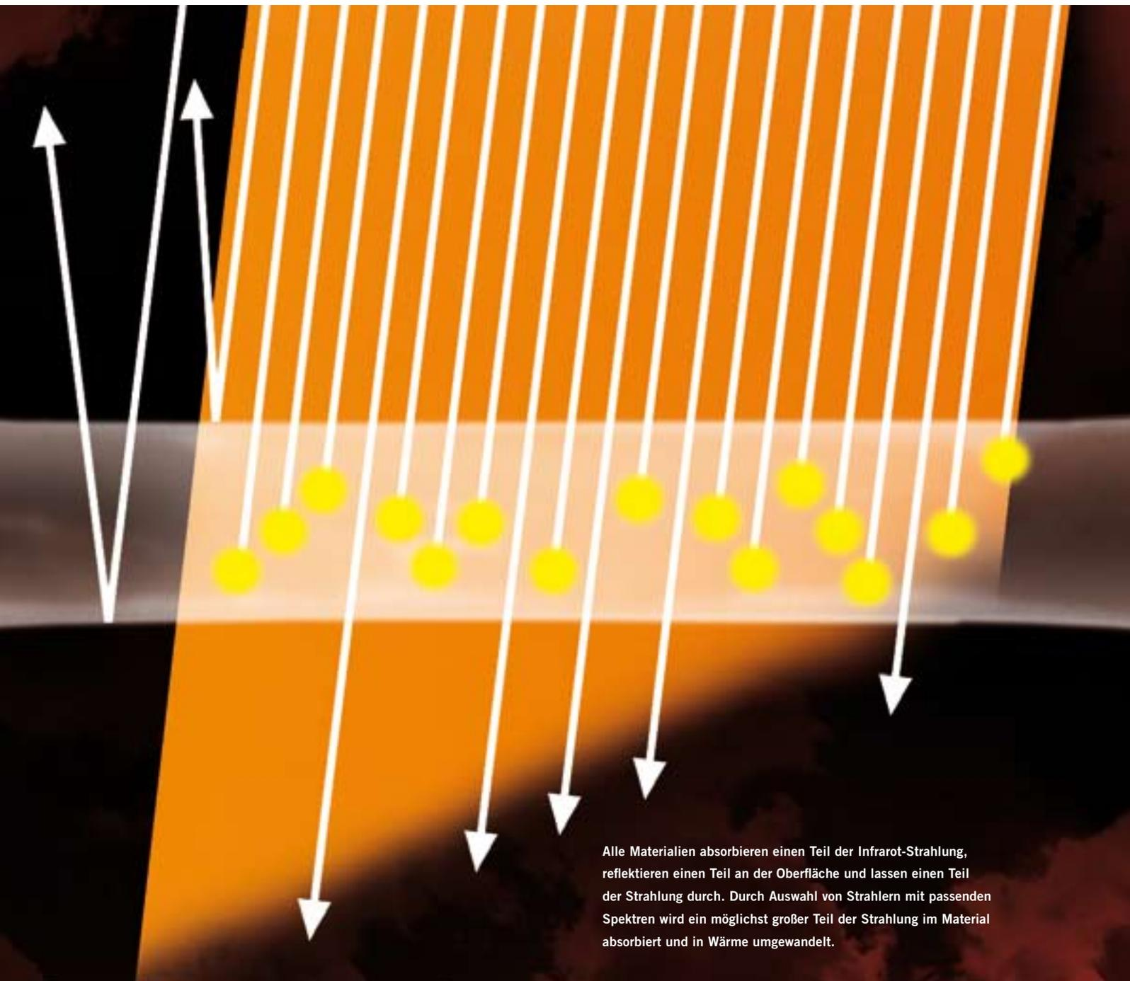
Alle Materialien absorbieren einen Teil der Infrarot-Strahlung, reflektieren einen Teil an der Oberfläche und lassen einen Teil der Strahlung durch. Durch Auswahl von Strahlern mit passenden Spektren wird ein möglichst großer Teil der Strahlung im Material absorbiert und in Wärme umgewandelt.
