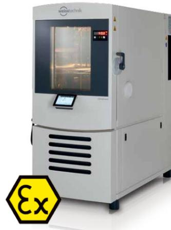
Falls Sie alkoholhaltige Proben prüfen und das Austreten von Dämpfen nicht sicher ausschließen können, müssen Sie eine Risikoanalyse durchführen und entsprechende Sicherheitsmaßnahmen gemäß der Klassifizierung nach ATEX ergreifen.
