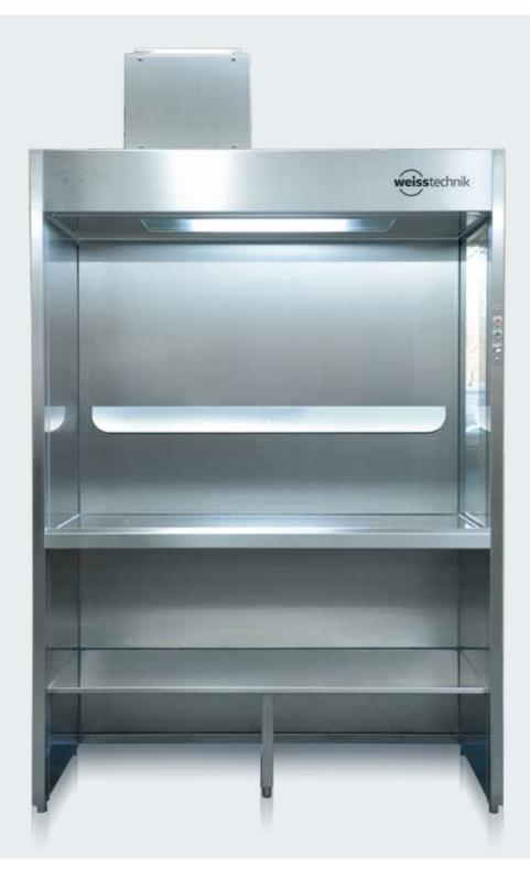
In der Basisversion bietet Ihnen der WIBOjekt®-Arbeitstisch Typ TCRJO flexible Einsatzmöglichkeiten. Das strömungsgerichtete Luftführungsprinzip verhindert zuverlässig Produktverwirbelungen. Die spezielle Form und Anordnung der WIBO®-Ejektordüsen sorgt für stabile Luftführung und robustes Rückhaltevermögen des Reinluftschleiers. Alle WIBOjekt®-Arbeitstische lassen sich in Bezug auf Maße und Ausstattung individuell gestalten.
