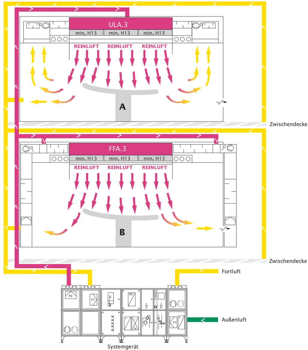
MEDICLEAN®-Systemgeräte können einen oder mehrere OPs gleichzeitig mit Frischluft versorgen. Die optionalen redundanten Lüfter gewährleisten dabei höchste Sicherheit. Die Zeichnung oben zeigt, wie ein MEDICLEAN®-Systemgerät zwei Reinluftdecken in zwei OPs in unterschiedlichen Ebenen betreibt.
